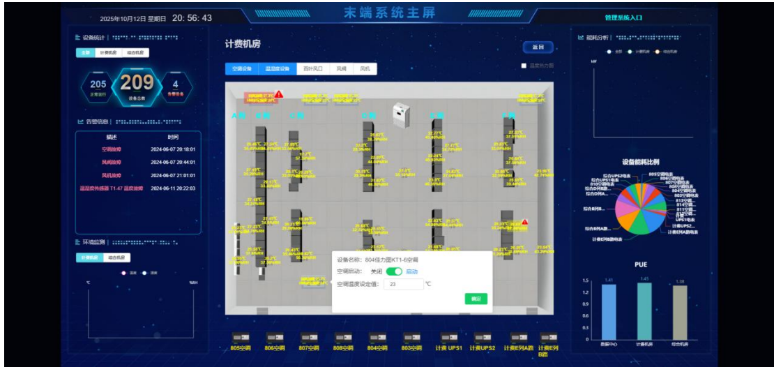
图 2.12.2 末端系统大屏下展示和设置设备的测点数据
